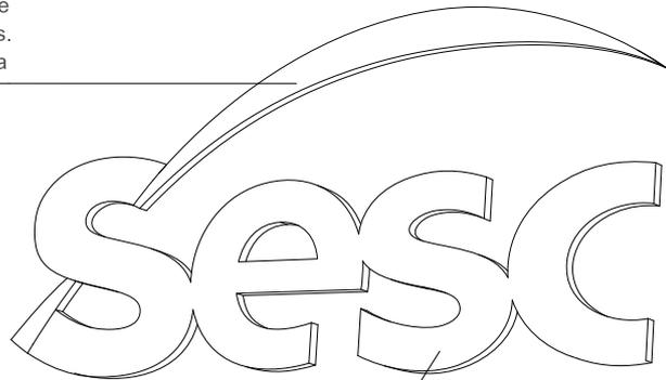
Letra-caixa (face + laterais) montadas em acrílico opaco 10 mm azul Pantone 288 C fixados diretamente na fachada através de espaçadores. O conjunto deve ter distanciamento de 3 cm da fachada
