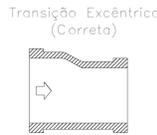
As transições de diâmetro das tubulações deverão ocorrer, obrigatoriamente, de maneira excêntrica. Esta maneira garante a livre passagem do condensado, fazendo com que o mesmo flua livremente através da tubulação. A transição concêntrica prejudica o escoamento do condensado, fazendo com que se acumule nos locais anteriores à transição.
