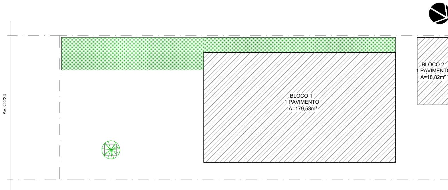
PLANTA DE SITUAÇÃO - TOTAL ÁREA CONSTRUÍDA: 198,35m<sup>2</sup>
